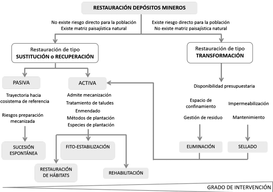
Figura 3.6. Ejemplo del proceso de toma de decisiones para seleccionar el modelo de restauración más apropiado para depósitos de lavado de residuos minero-metálicos.
